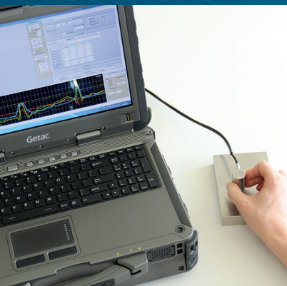
Links: Mobiles Wirbelstromprüfsystem; rechts: Kundenspezifisches Vielkanalprüfsystem
