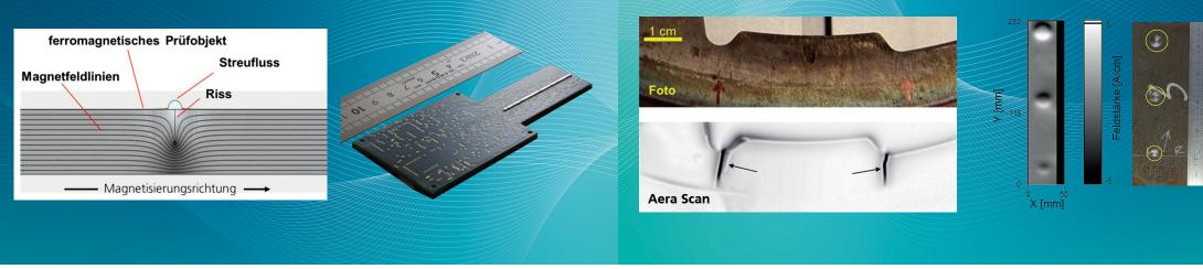
1: Prinzip Streufluss; 2: Hochempfindliche Magnetfeldsensorzeile
