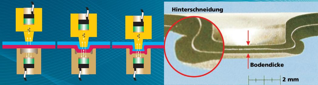
Links: Skizze zur Online-Bestimmung der Bodendicken im Fügepunkt mit Ultraschallverfahren; rechts: Hinterschneidung in der Fügezone und Qualitätsmerkmal Bodendicke
