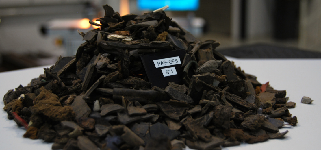
Schwarze Kunststoffe kommen häufig in der Schredderleichtfraktion vor. Ziel ist eine Anreicherung des wertvollen Polyamid 6 aus diesem Materialstrom.
