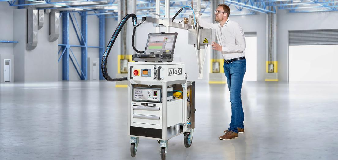
*AloX: Sensorsystem zum Nachweis von nichtmetallischen Einschlüssen in Aluminiumschmelze*
