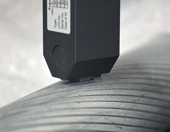
Links: Bestimmung der Härtetiefe mit 3MA-X8; Mitte: Bestimmung von Härte und Härtetiefe an induktions-, einatz- und nitriergehärteten Bauteilen
