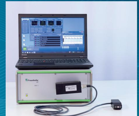
Die 3MA-Prüftechnik (Mikromagnetische Multiparameter-, Mikrostruktur- und Spannungsanalyse) als schnelleres und kostengünstigeres zerstörungsfreies Prüfverfahren erlaubt es, mehrere relevante Qualitätsmerkmale des Werkstoffs wie Härte und die Kenngrößen des Zugversuchs gleichzeitig zu bestimmen. Das Verfahren kann wahlweise händisch oder vollständig automatisiert eingesetzt und in den Fertigungsprozess integriert werden.
