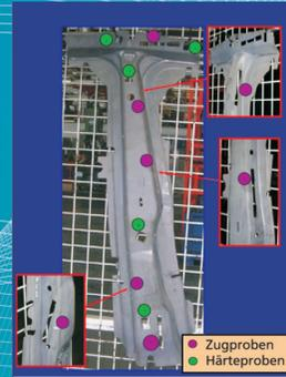
links: Verstärkungselemente der Automobilkarosserie (Quelle: Volkswagen); rechts: Bauteil mit markierten Prüfpositionen
