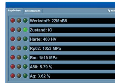
Ergebnis einer 3MA-Prüfung
