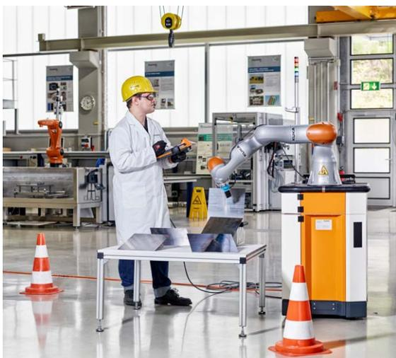
Durchführung einer robotergestützten Prüfung von Stahlplatinen. Untersucht werden mechanische Eigenschaften (Eigenspannungen u. a.) mittels mikromagnetischer Verfahren (3MA). (Foto Fraunhofer IZFP / Uwe Bellhäuser)
