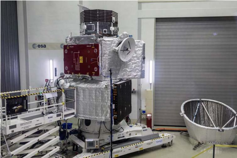
Die oben rechts im Bild befindliche kreisrunde sog. HGA-Antenne, die der Kommunikation des Satelliten mit dem Kontrollzentrum auf der Erde dient, wurde von der CeraNovis GmbH beschichtet. (Foto: ESA)
