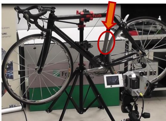
Abbildung 1: Thermographische Untersuchung eines Rennrades mit verstecktem E-Motor
