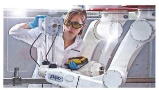
Luftultraschall: Ein mit dem Ultraschallprüfsystem verbundener Industrieroboter tastet das Bauteil ab Foto: Uwe Beilhäuser
