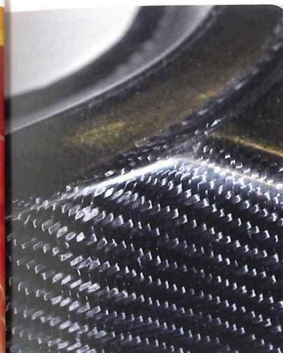
Carbon- und Hanffaserverstärktes Bauteil – Karosserie aus Baumwolle, Hanf und Holz. © Lingnau, Manuela
