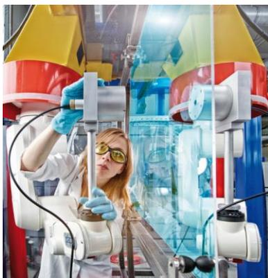
Luftultraschall: Ein mit dem Ultraschall-Prüfsystem verbundener Industrieroboter tastet das Bauteil ab.
