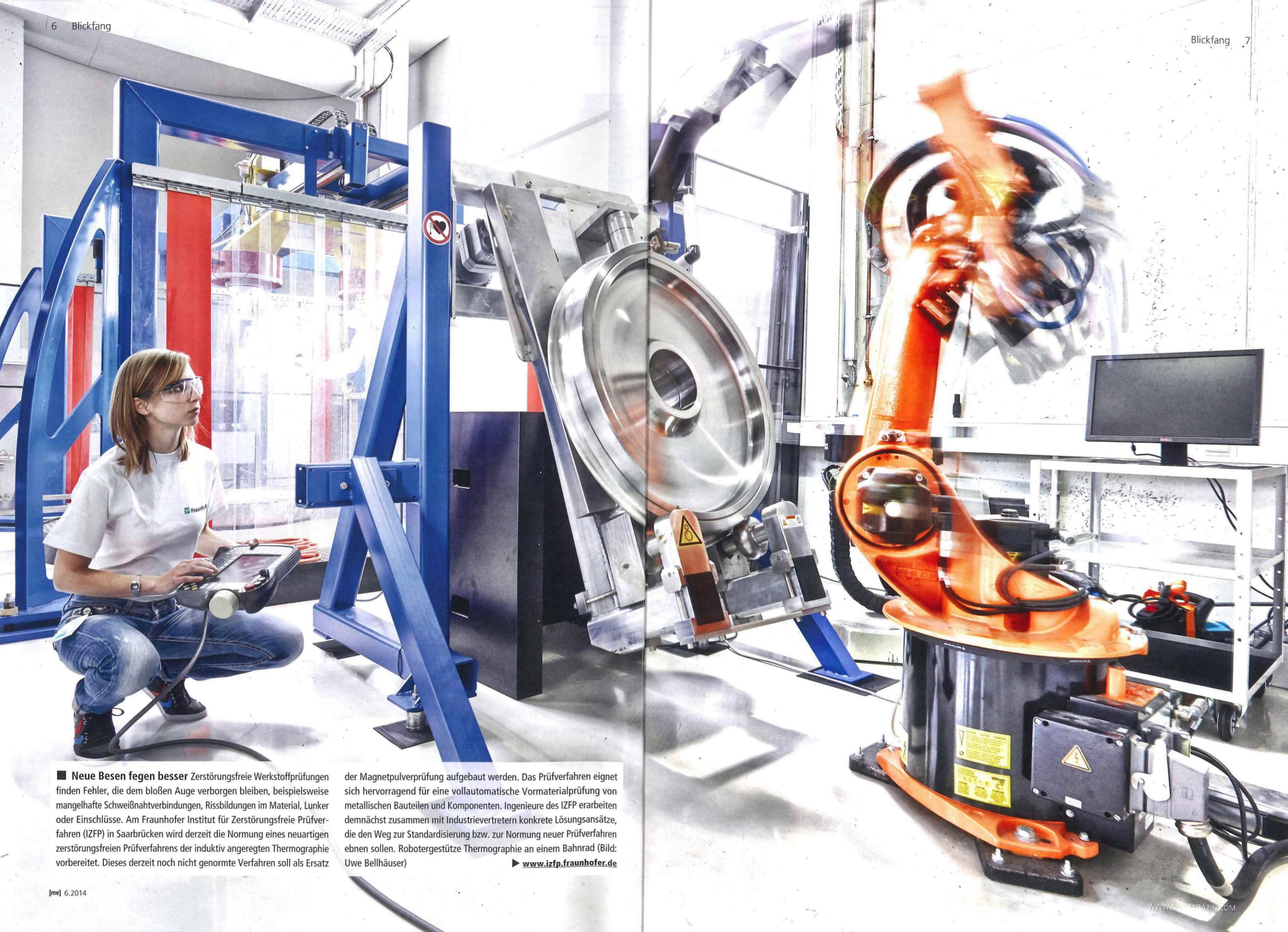
■ **Neue Besen fegen besser** Zerstörungsfreie Werkstoffprüfungen finden Fehler, die dem bloßen Auge verborgen bleiben, beispielsweise mangelhafte Schweißnahtverbindungen, Rissbildungen im Material, Lunker oder Einschlüsse. Am Fraunhofer Institut für Zerstörungsfreie Prüfverfahren (IZFP) in Saarbrücken wird derzeit die Normung eines neuartigen zerstörungsfreien Prüfverfahrens der induktiv angeregten Thermographie vorbereitet. Dieses derzeit noch nicht genormte Verfahren soll als Ersatz
