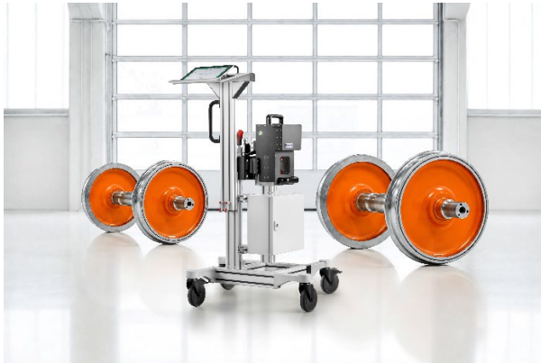
Abb. 1: UER-System: Ultraschall-Eigenspannungsprüfung an Bahnradern; © Fraunhofer IZFP/André Köhl
