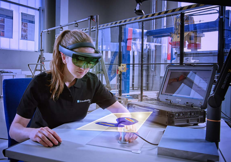
Mit 3D-SmartInspect in die digitale ZfP-Welt: AR-System zur manuellen Bauteilprüfung mit automatischer Dokumentation in DICONDE
