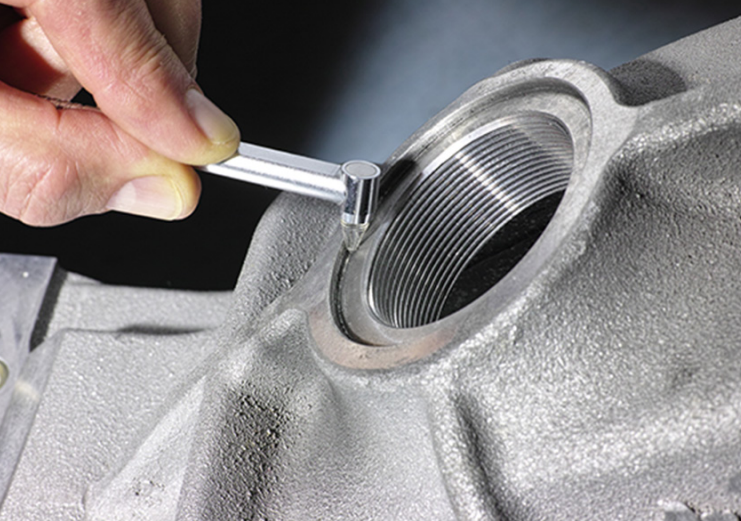
Links: Ultraschallsensor zur Abtastung kleiner Radien in Kontakttechnik; Mitte: Aufbau zur Manipulator-gesteuerten Ultraschallprüfung in Kontakttechnik
