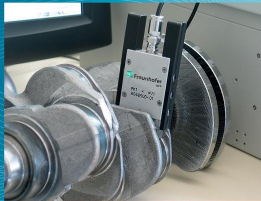
Links: P3123 – Mobiles SHD-Prüfgerät; rechts: Kurbelwellenprüfung mit SHD-Sensor
