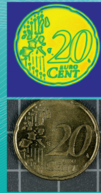
Links: Auflösungsvermögen Luftultraschallprüfung Münze, 1 MHz; rechts: Prüfung eines Hybridwerkstoffs
