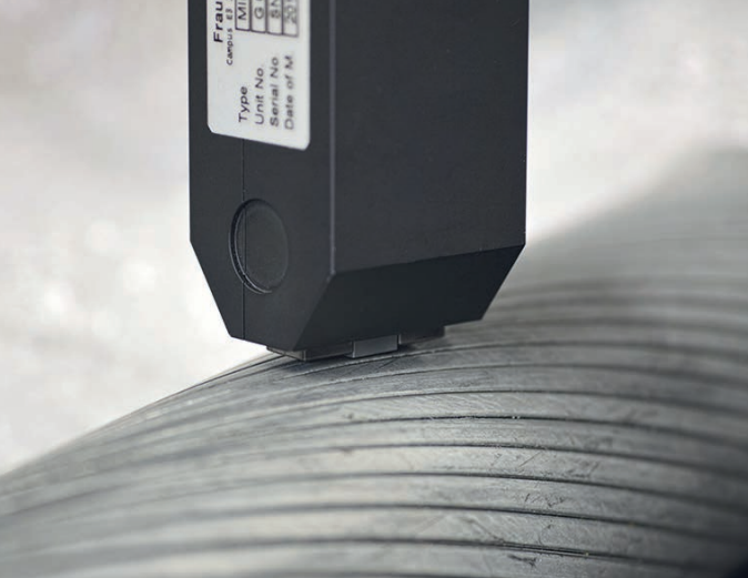
links: Bestimmung der Härtetiefe mit 3MA-X8; Mitte: Bestimmung von Härte und Härtetiefe an induktions-, einsatz- und nitriergehärteten Bauteilen
