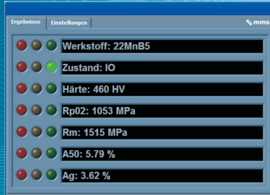
links: Zweiteiliger Prüfkopf zur automatisierten Prüfung von Zahnrädern; rechts: Ergebnisdarstellung der 3MA-Messung eines pressgehärteten Karosserieteils
