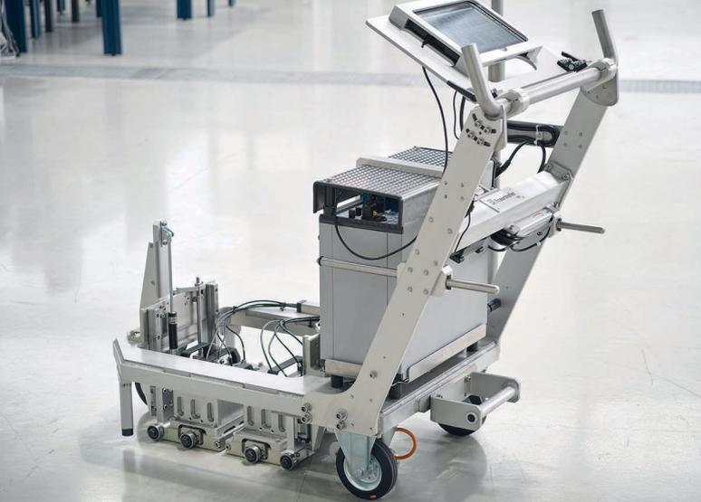
Achtkanaliger Handwagen zur Detektion von Hardspots
