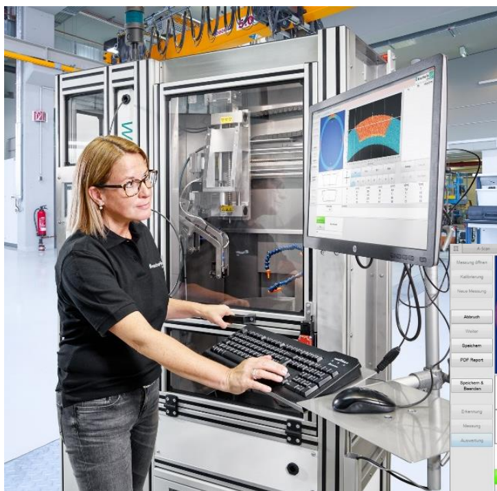
Bild links: Teilautomatisierte Anlage zur Vermessung der Schweißnahtgeometrie von Abtriebswellen für das 8-Gang-Pkw-Automatikgetriebe der ZF Friedrichshafen AG, Werk Saarbrücken
