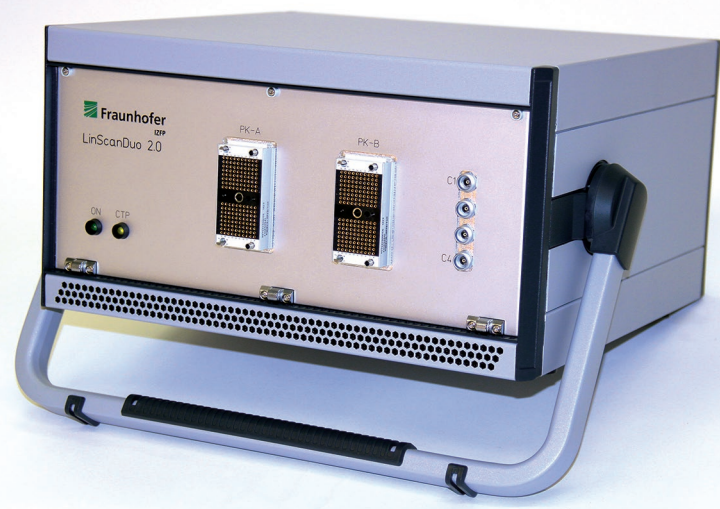
LinScanDuo 2.0 – Ultraschallapplikation auf Basis der Fraunhofer IZFP eigenen OPTHUS-Elektronik für Erntemaschinen
