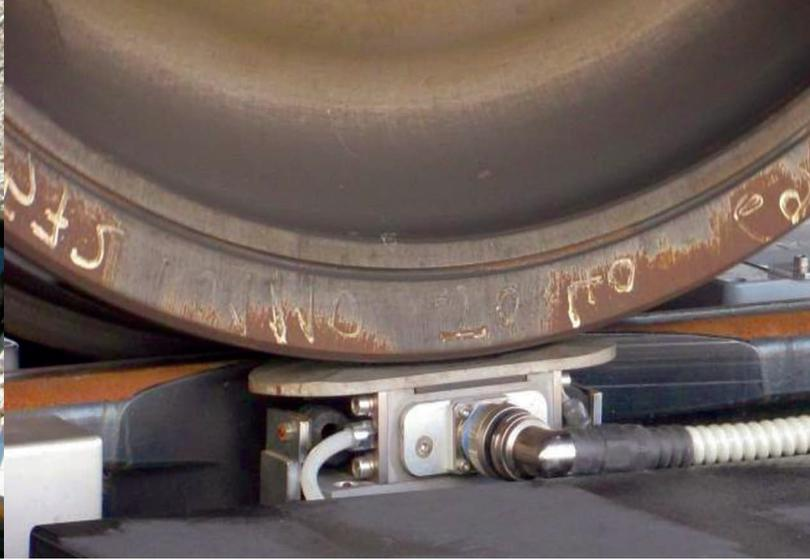
Moderne Ausführungsform eines AUROPA-Inspektionsgleises (links), Eisenbahnrad auf EMUS-Prüfkopf im Überrollbetrieb (rechts)
