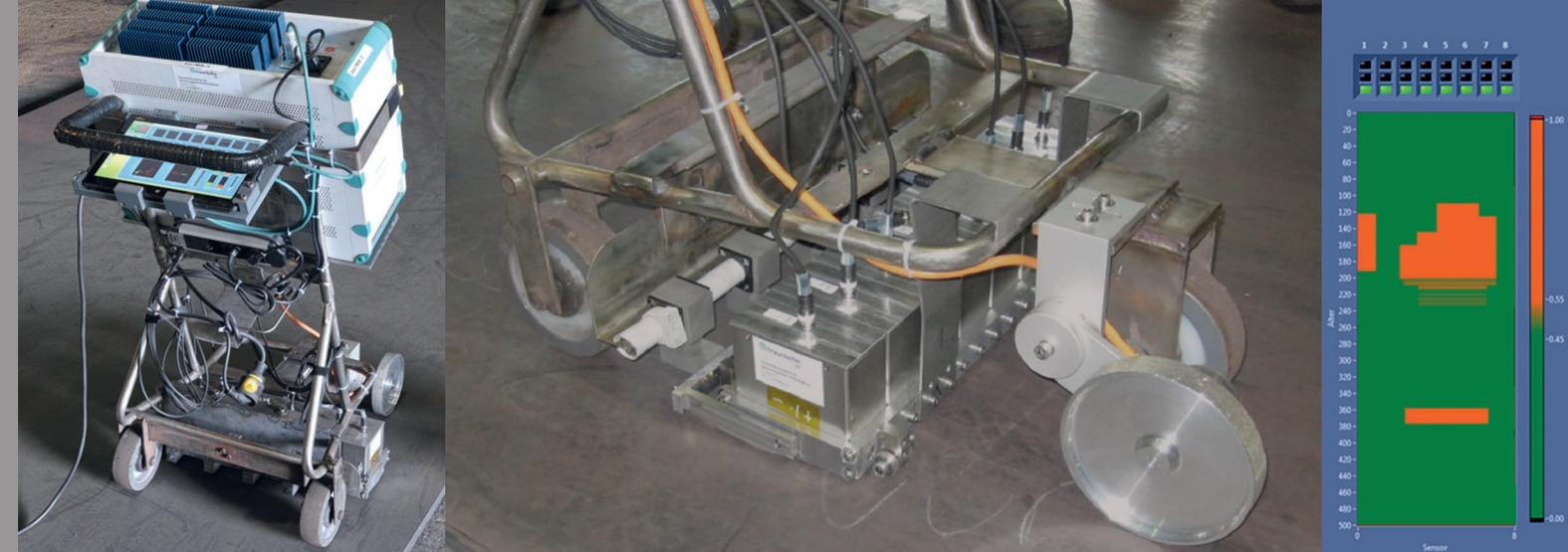
3MA-X8 (links), Sensorzeile des Prüfwagens mit Weggeberrad (Mitte), Ergebnisdarstellung, i.O. - grün / n.i.O. - orange (rechts)
