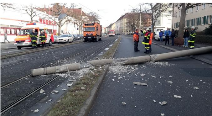
1 Infolge Korrosion umgestürzter Betonmast
