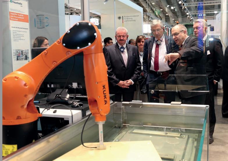
Prof. Hanke erläutert anlässlich der Hannover Messe 2014 dem Vorstand der Fraunhofer-Gesellschaft die robotergestützte Ultraschall-Prüfung von Faser-verbundbauteilen
