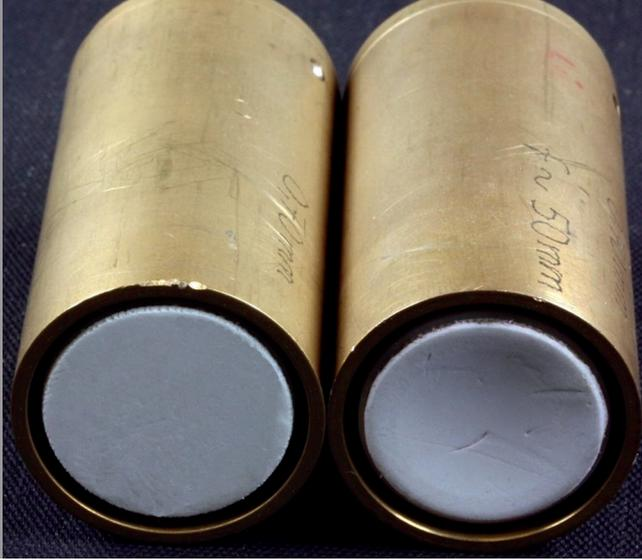
1 Luftultraschallwandler in ebener (links) und fokussierter (rechts) Bauart; Mittenfrequenz 500 kHz
