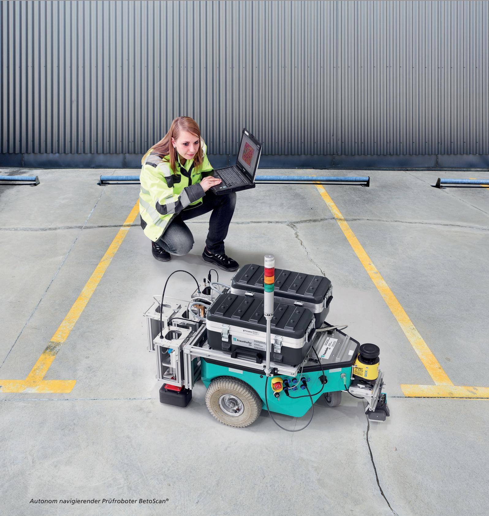
Autonom navigierender Prüfroboter BetoScan®
