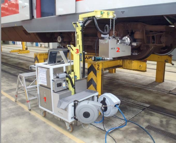
1 Mobiles Hohlwellenprüfsystem während des Einsatzes an einem Zug
