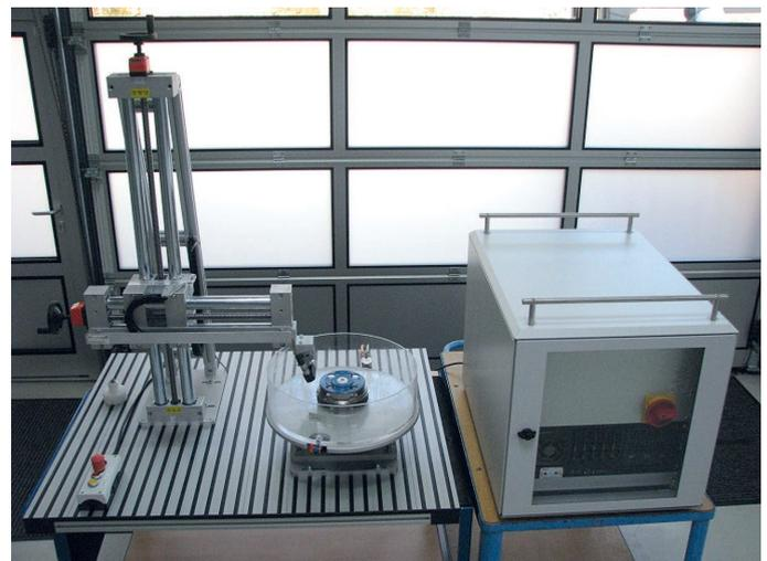
1 Setup: Sechssachsiger Ausleger mit Prüfkopfträger; rechts: Ultraschallsystem mit Wandlerkarte
