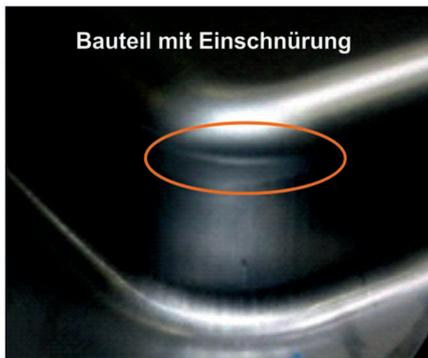
2 Bauteil mit Einschnürung, schematische Darstellung der Schallausbreitung und Ultraschallsignal
