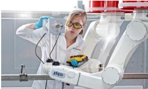
Luftultraschall: Ein mit dem Ultraschall-Prüfsystem verbundener Industrieroboter tastet das Bauteil ab.
