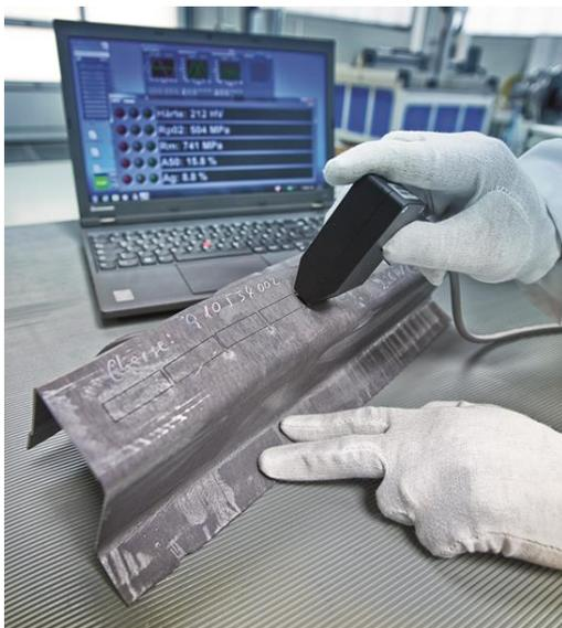
3MA-Prüfverfahren – Prozessintegriert, zuverlässig und sekundenschnell.
